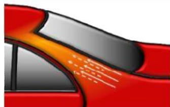
Miscelare Permasolid HS Automotive Top Coat 275 secondo la TDS. Applicare Permasolid HS Automotive Top Coat 275 pronto all'uso per coprire l'area preparata e sfumare in mani leggere con pressione ridotta all'interno dell'area di sfumatura carteggiata.
