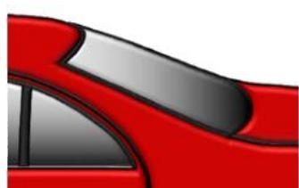
Carteggiare l'area di sfumatura e il passaggio alla verniciatura originale esistente, ad es. con 3M Trizact P3000 Fine Finishing Disc o abrasivi simili di altri fornitori.
