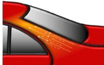
Applicare Permacron Speed Blender 1036 in diverse mani leggere con pressione ridotta nell'area di sfumatura. Dissolvere l' overspray e levigare l'area di transizione di Permasolid HS Automotive Top Coat 275 e restare nell'area di sfumatura cartecciata con P3000. Facoltativo: rimanere nell'area di sfumatura lucidato. Essiccare secondo la TDS di Permasolid Automotive Top Coat 275.
