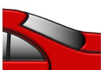
Un'ulteriore essiccazione IR dell'area di sfumatura puo' ridurre il rischio di arretramento del bordo una volta lucidato. Se necessario, carteggiare leggermente la zona di transizione dopo l'essiccazione e il raffreddamento a seconda della finitura da raggiungere, ad es. con 3M Trizact P3000 o simile. Lucidare usando una macchina lucidatrice rotante. Assicurarsi di controllare la pressione e la direzione di rotazione dal topcoat finale all'area di sfumatura.
