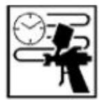
La durata del prodotto catalizzato, ovvero il tempo utile per l'applicazione è circa 3 ore a 25 °C; in funzione dell'applicazione si consiglia la preparazione di una quantità adeguata di prodotto in modo da garantirne la lavorabilità ottimale.
