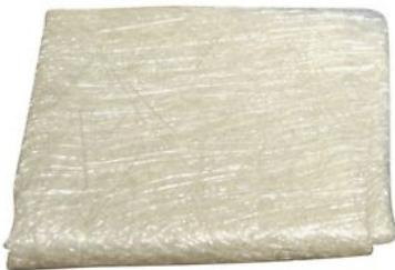
Le fibre di rinforzo sono la struttura meccanica del composito e si possono paragonare ai tondini d'acciaio nel cemento armato. Questi prodotti si presentano con un legante in polvere o liquido e sono sviluppati per essere utilizzati in combinazione con resine ortoftaliche, isoftaliche, vinilesteri, epossidiche. Sono ideali per la produzione e riparazione di barche, contenitori per agenti chimici, parti di veicoli e attrezzature sportive.
